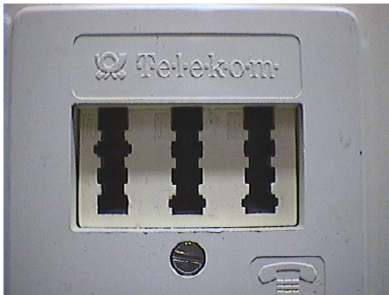
Bild1: Die Netz-Monopoldose – die es „eigentlich“ nicht mehr so ganz gibt.
